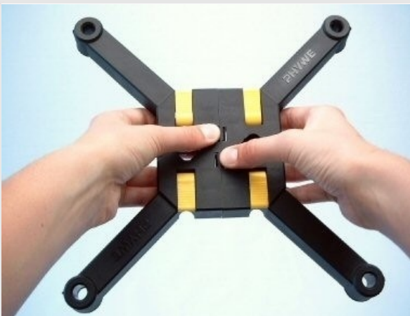
Desmontando la base del trípode
