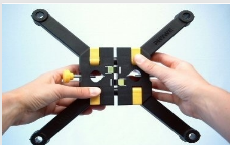
Ensamblando la base del trípode
